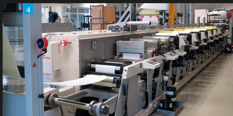
1) Il reparto di stampa tipografica di Insignis Etiketten. 2) La macchina da stampa digitale Xeikon 3300 con tecnologia a toner. 3) Etichette di alta qualità con stampa serigrafica e differenti tipologie di embossing e foiling. 4) Una delle linee di produzione Nilpeter installate presso l'etichettificio austriaco.
